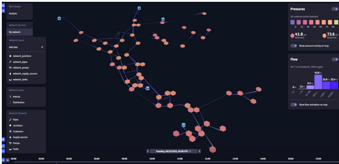
Figura 5 - Dashboard desenvolvido em DT com KPIs de caudal, nível, velocidade e previsões meteorológicas.
